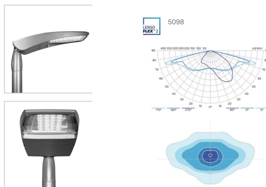
Rysunek nr 1. Kształt obudowy rozsyłu światła drogowej oprawy oświetleniowej.
